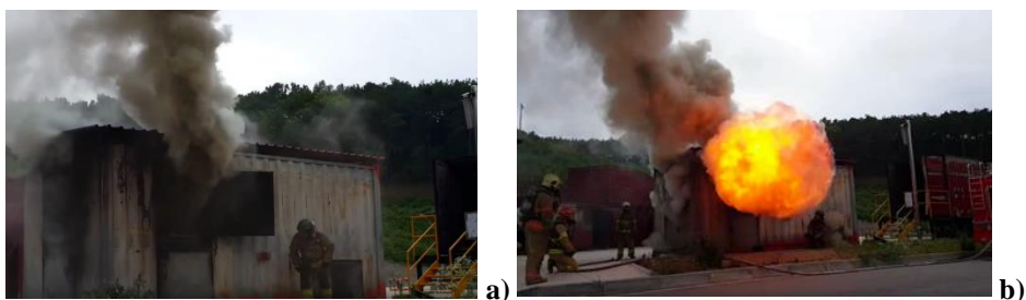
Figura nr. 152 – Eliminarea condițiilor apariției de backdraft pentru a facilita accesul în clădire: a) semn al apariției backdraft-ului, b) producerea backdraft-ului 145
