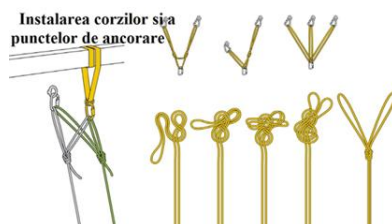
Figura nr. 93 – Instalarea punctelor de ancorare 88
