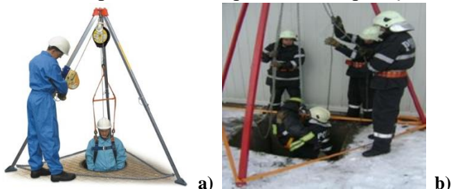
Figura nr. 118 – Salvarea din puț folosind trepiedul: a) echipamentul necesar 113 , b) tehnica de salvare 114
